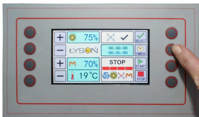
Фото 6 Установка времени работы оборудования (таймер)
