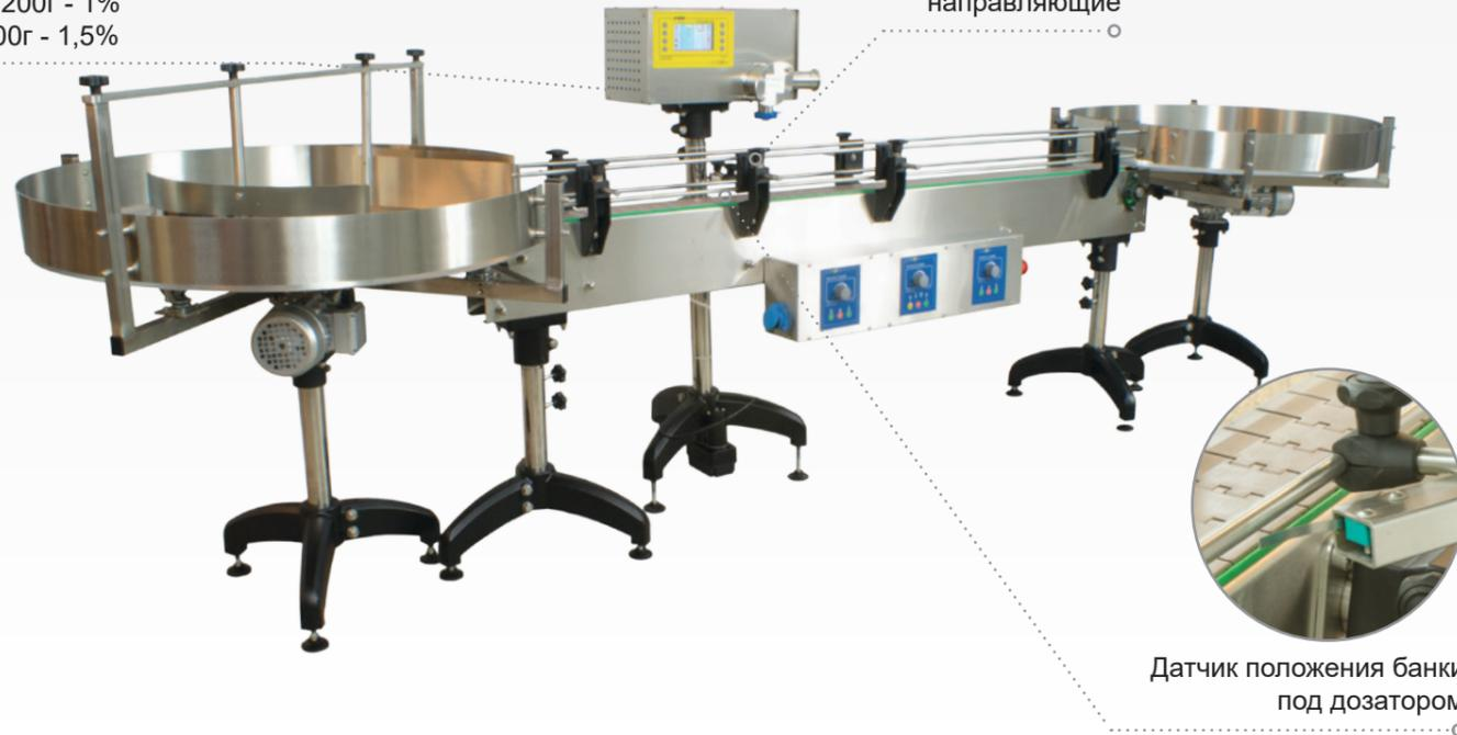
Датчик положения банки под дозатором
