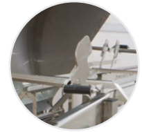
Рычаг, блокирующий корзину медогонки
