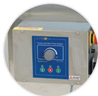
Возможность регулировки скорости и направления оборотов
